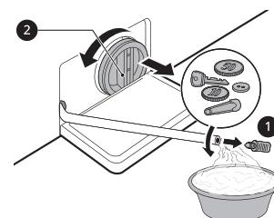
**4** Efter rengøring af afløbspumpefilteret skal du forsigtigt indsætte filteret igen og skru afløbshætten tilbage med uret for at undgå skævdrejning og lækage. Sæt stikket ind i afløbsslangen igen, og placér røret i dets holder.
