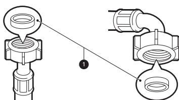
**Anslutning av slang till vattenkran****Anslutning av slang med skruvkoppling till kran med gänga**
